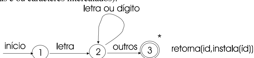
Figura 1 – Diagrama de transição para reconhecimento de um identificador.
